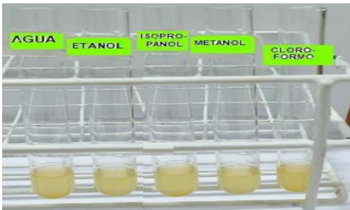
Figura 02. Prueba de solubilidad del extracto hidroalcohólico de Mirabilis jalapa “maravilla”
