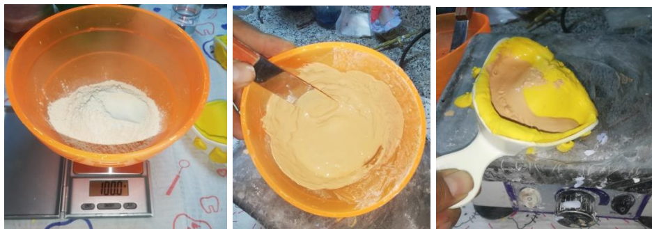
Proporciones ideales según fabricante para el vaciado con yeso tipo IV
