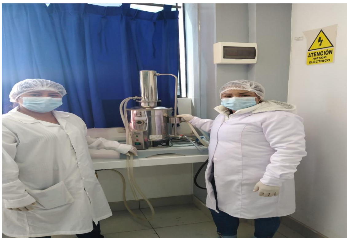
Fotografía 2. Conexión del equipo para la destilación por arrastre de vapor de agua
