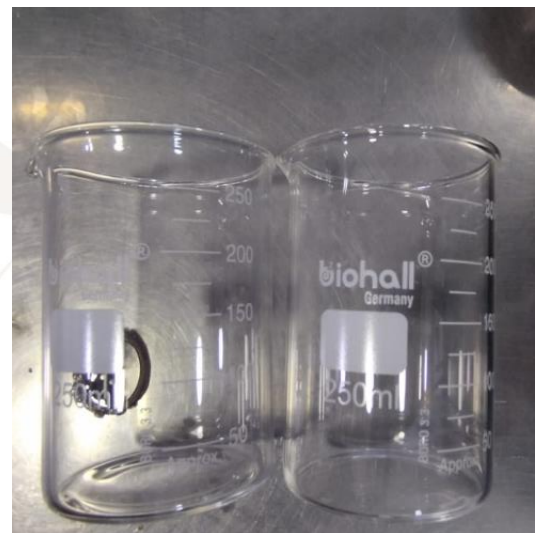
Recipientes cilíndricos de vidrio borosilicatado fino que se utiliza muy comúnmente en el laboratorio, sobre todo, para preparar o calentar sustancias, medir o traspasar líquidos.
