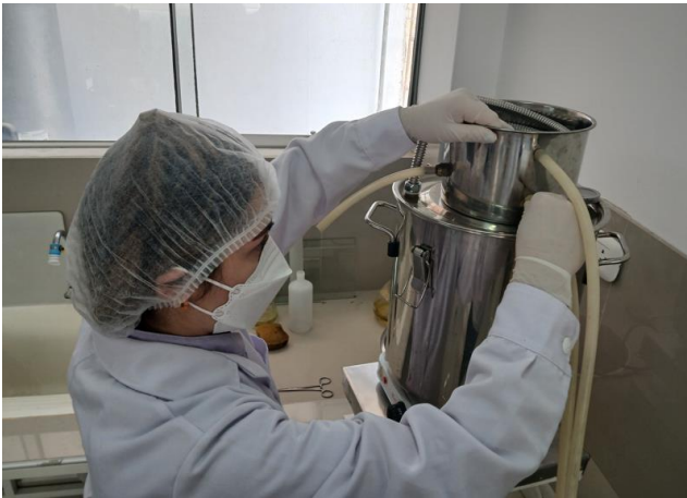
Figura 1. Armado del equipo de destilación por arrastre de vapor y obtención del aceite esencial
