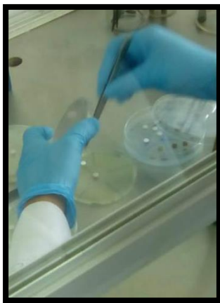
Figura N°20: Preparación de discos con extracto de Anarcardium occidentale L. (marañón) al 100 %, 75 % y 50%, ketoconazol y suero fisiológico.
