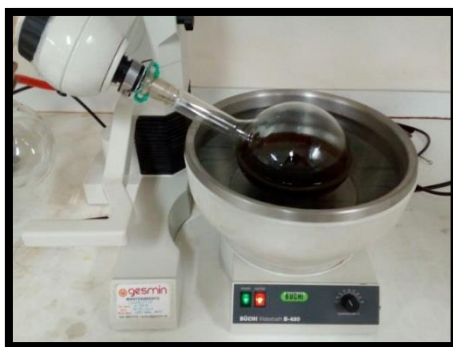
Figura N°8: Proceso de extracción hidroalcohólico de Anacardium occidentale L. (marañón) mediante la extracción en rotavapor.
