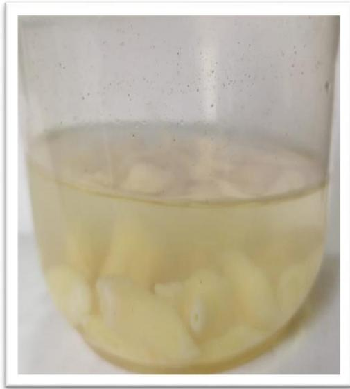
**Figura N° 16. Las muestras en ácido nítrico al 6% por 24 horas**
