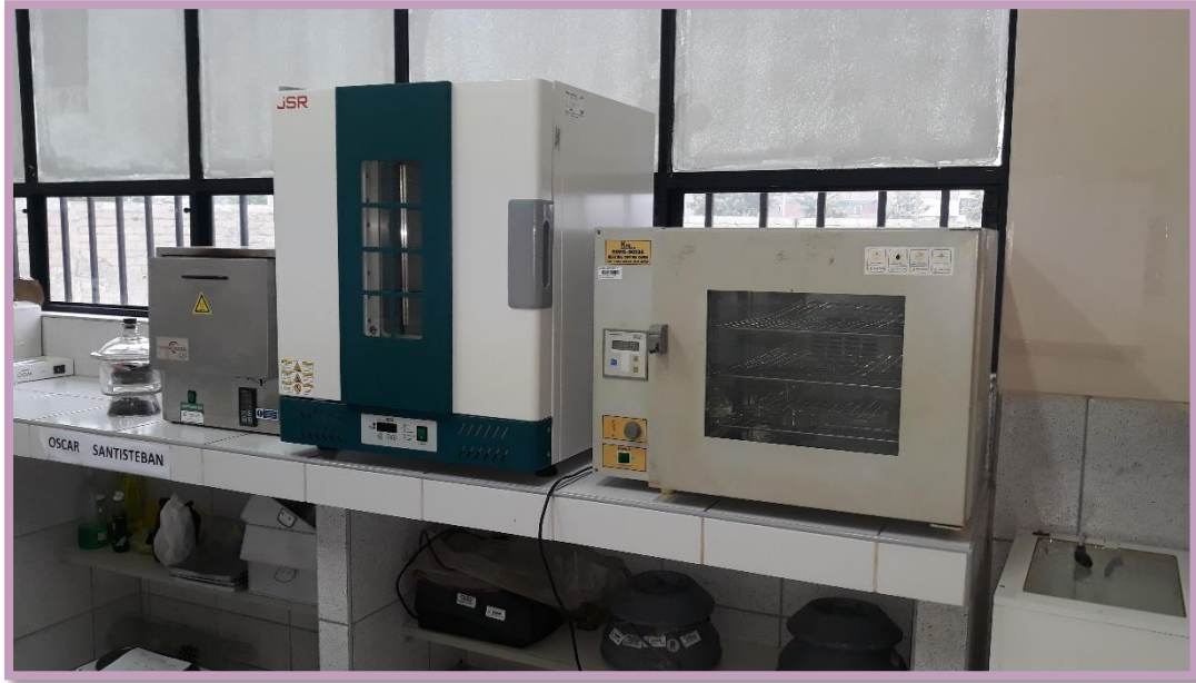
Figura N°5: Estufa donde se colocó Mentzelia scabra subp. chilensis (Gay) Weingend “Anguarate” a una temperatura de 40°C, para evitar la pérdida de componentes volátiles.
