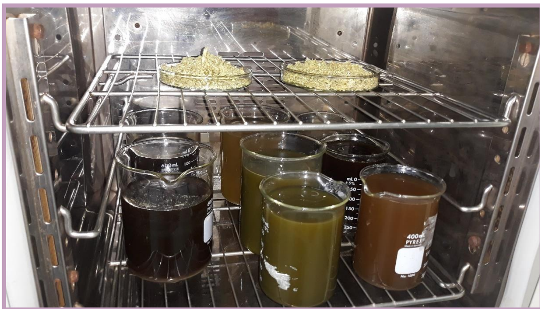
Figura N°8: Vasos de precipitado conteniendo extractos acuosos para ser concentrados a una temperatura inferior a 60°C. La estufa es de aire circulante.
