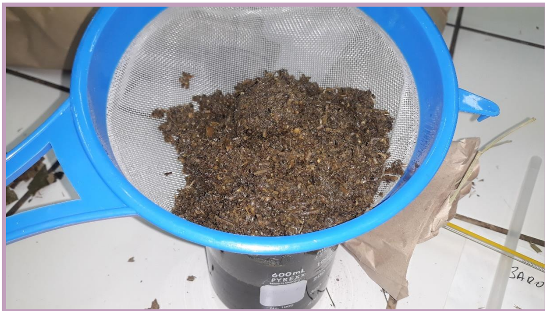
Figura N°7: Retención de material particulado mediante un tamiz de polipropileno
