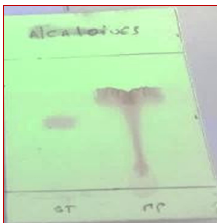
Figura N° 22: Identificación de Alcaloides por cromatografía de capa fina
