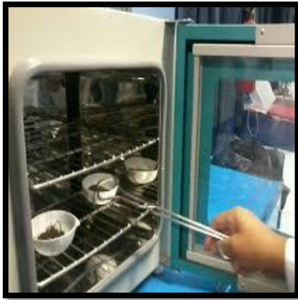
Figura N° 8: Cápsulas de porcelana con extracto de cola de caballo evaporándose a sequedad para evaluar la capacidad extractante
