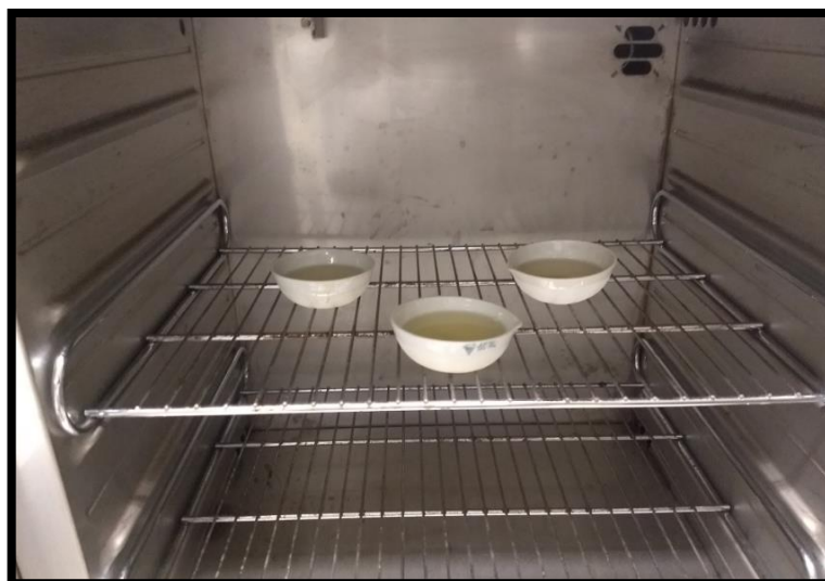
Fotografía 5: La muestra filtrada de las hojas de “poro” en la estufa. Fuente: Elaboración propia
