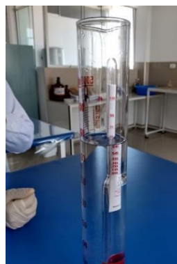
Figura 4. Medición del grado alcohólico Gay Lussac
