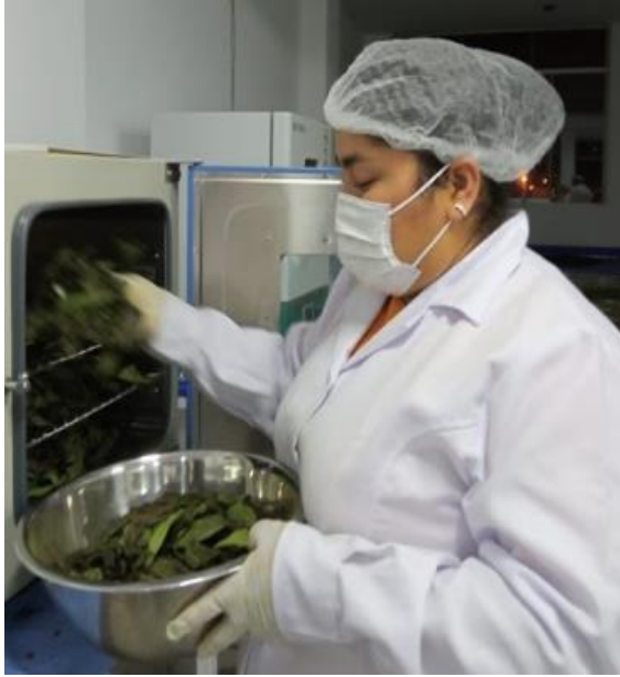
Figura 6. Secado y deshidratación de la muestra en estufa
