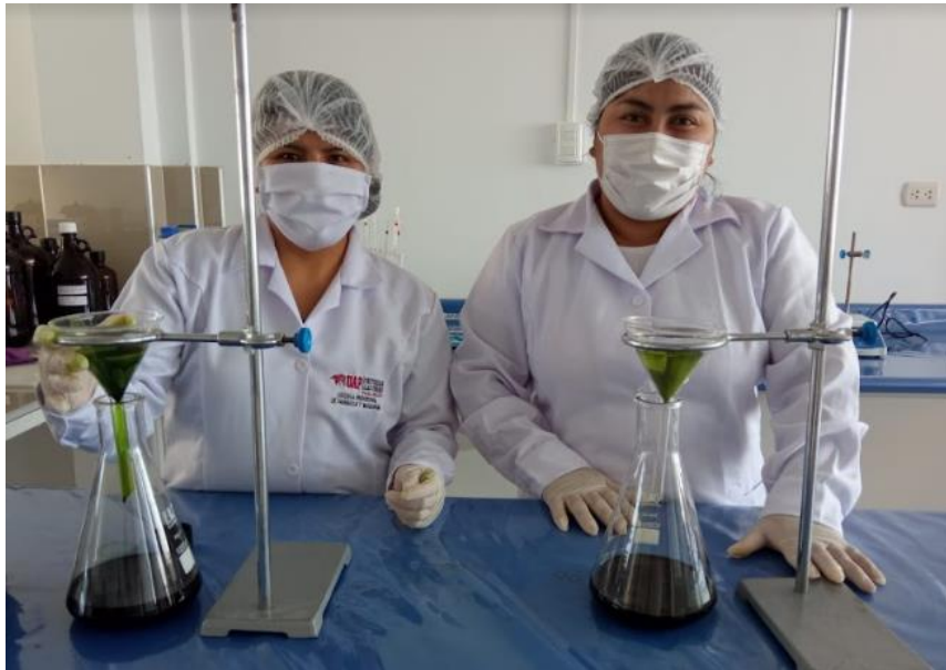
Figura 9. Filtración de los macerados de ambas muestras
