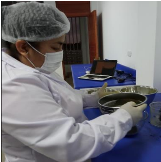
Figura 7. Trituración, pulverizado, tamizado y maceración de las muestras
