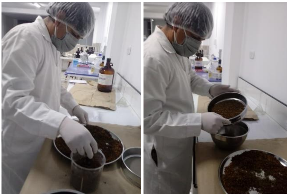
Figura 5, Pulverización y tamizado de la muestra vegetal
