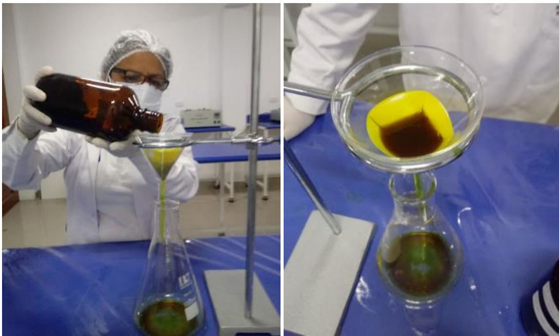
Figura 7, Filtración del macerado
