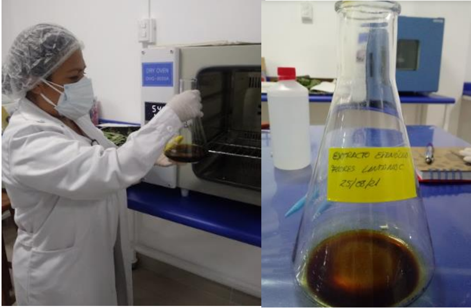
Figura 8, Evaporación del solvente y extracto obtenido
