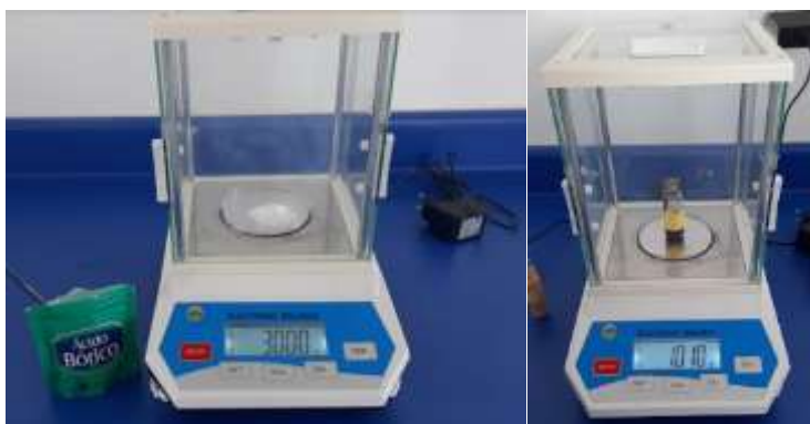
Figura 11. Pesaje de los componentes del enjuague
