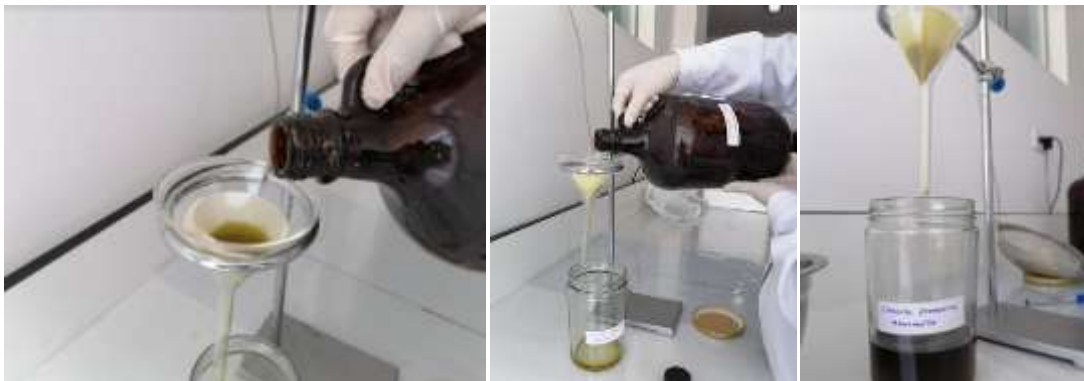
Figura 8. Filtración de la muestra
