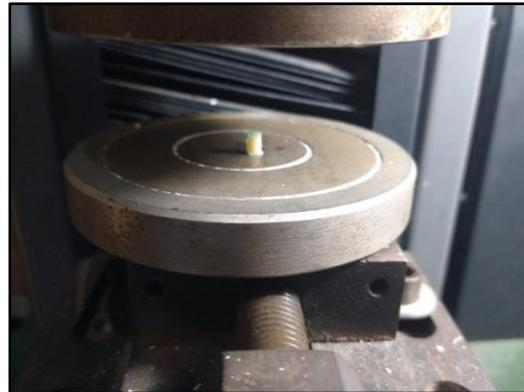
**Figura 6:** Las fuerzas de compresión tuvieron una velocidad de ensayo de 1mm por minuto y una celda de carga de 500 kg o 5 kilo newtons.
