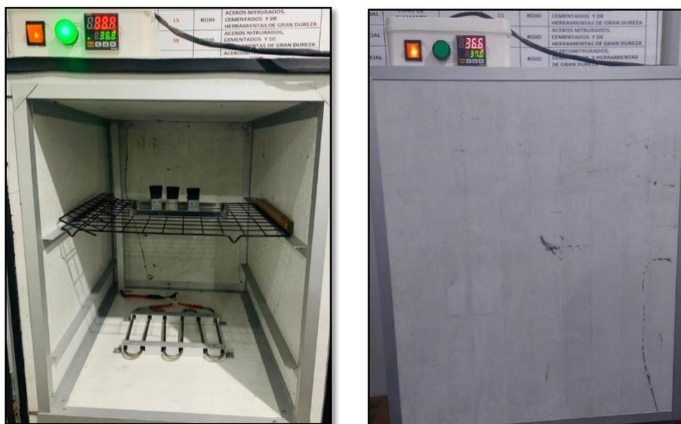
**Figura 4:** Los especímenes fueron y almacenados a 37°C en una incubadora por 24 horas, simulando las condiciones orales.
