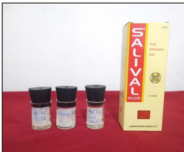
**Figura 3:** Especímenes de los cementos ionoméricos del grupo A, B y C sumergidos en 5ml de saliva artificial.
