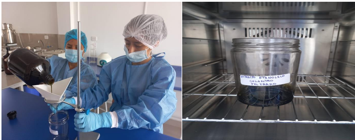
FIGURA 6. Filtrado y evaporización del extracto etanólico Coriandrum sativum L. (Culantro)
